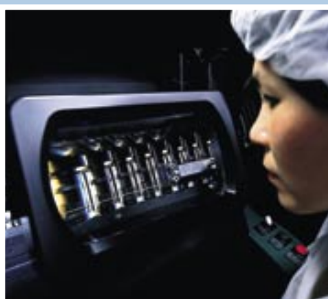
Toutes les cartouches passent sur un tapis roulant et sont soumises aux yeux infaillibles des personnes qui assurent le "mirage".
